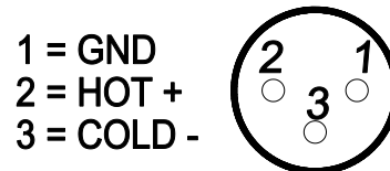
Fig.2 Collegamento Ingresso / Uscita XLR Bal
